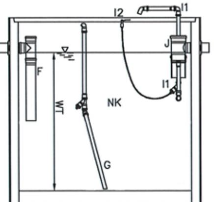
Nachrüstatz Typ Picobells für den Einbau in bestehende Abwasserbehandlungsanlagen zur Herstellung von Kleinkläranlagen für 4 bis 50 EW; Ablaufklasse C
