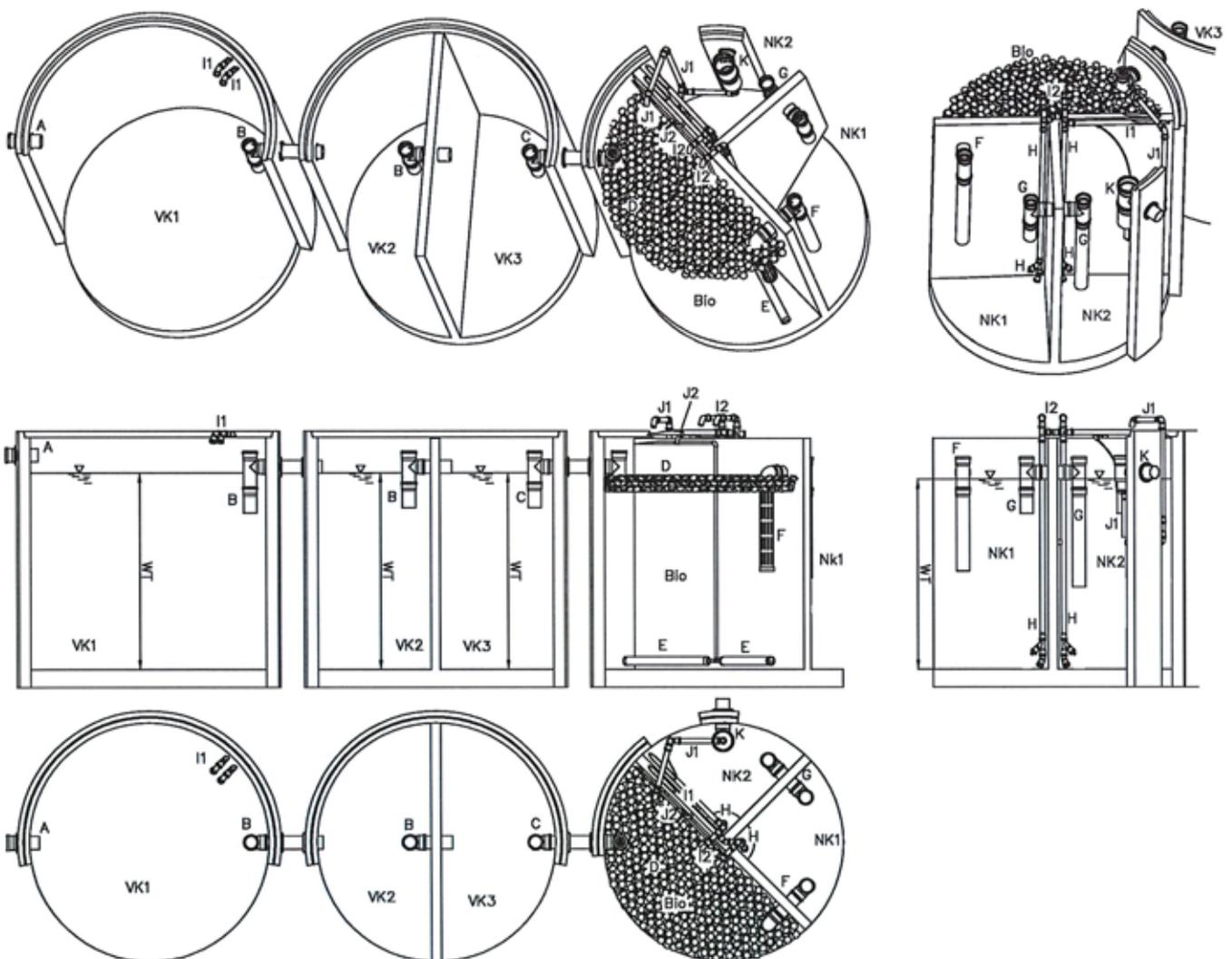
Nachrüstset Typ Picobells für den Einbau in bestehende Abwasserbehandlungsanlagen zur Herstellung von Kleinkläranlagen für 4 bis 50 EW; Ablaufklasse C
