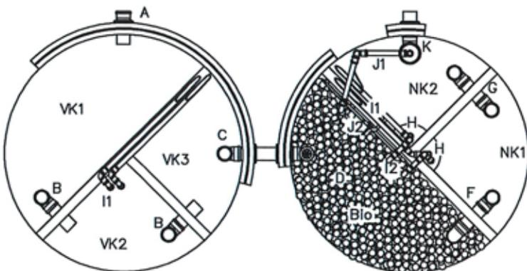
Nachrüstsatz Typ Picobells für den Einbau in bestehende Abwasserbehandlungsanlagen zur Herstellung von Kleinkläranlagen für 4 bis 50 EW; Ablaufklasse C
