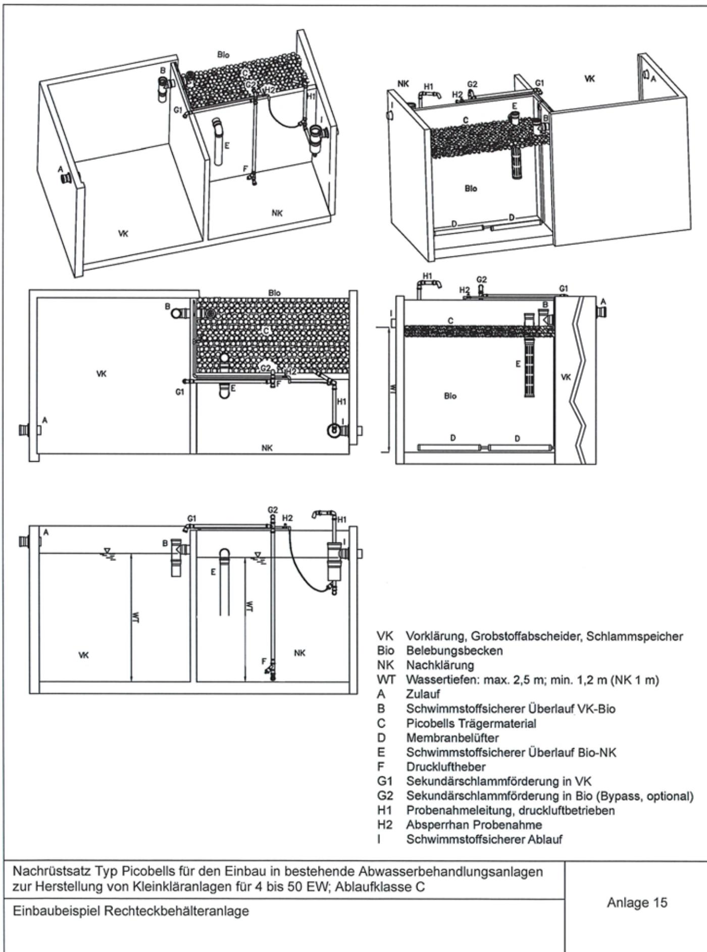
Klärtechnische Berechnung für Ein- u. Mehrbehälterausführungen: (Einkammer Vorklärung)
