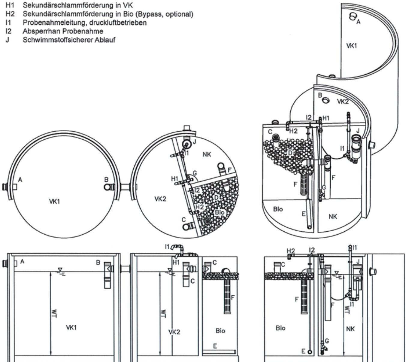
Nachrüstatz Typ Picobells für den Einbau in bestehende Abwasserbehandlungsanlagen zur Herstellung von Kleinkläranlagen für 4 bis 50 EW; Ablaufklasse C
