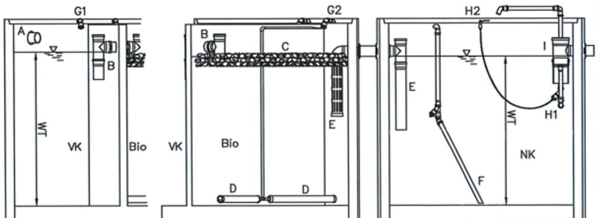
Nachrüstset Typ Picobells für den Einbau in bestehende Abwasserbehandlungsanlagen zur Herstellung von Kleinkläranlagen für 4 bis 50 EW; Ablaufklasse C
