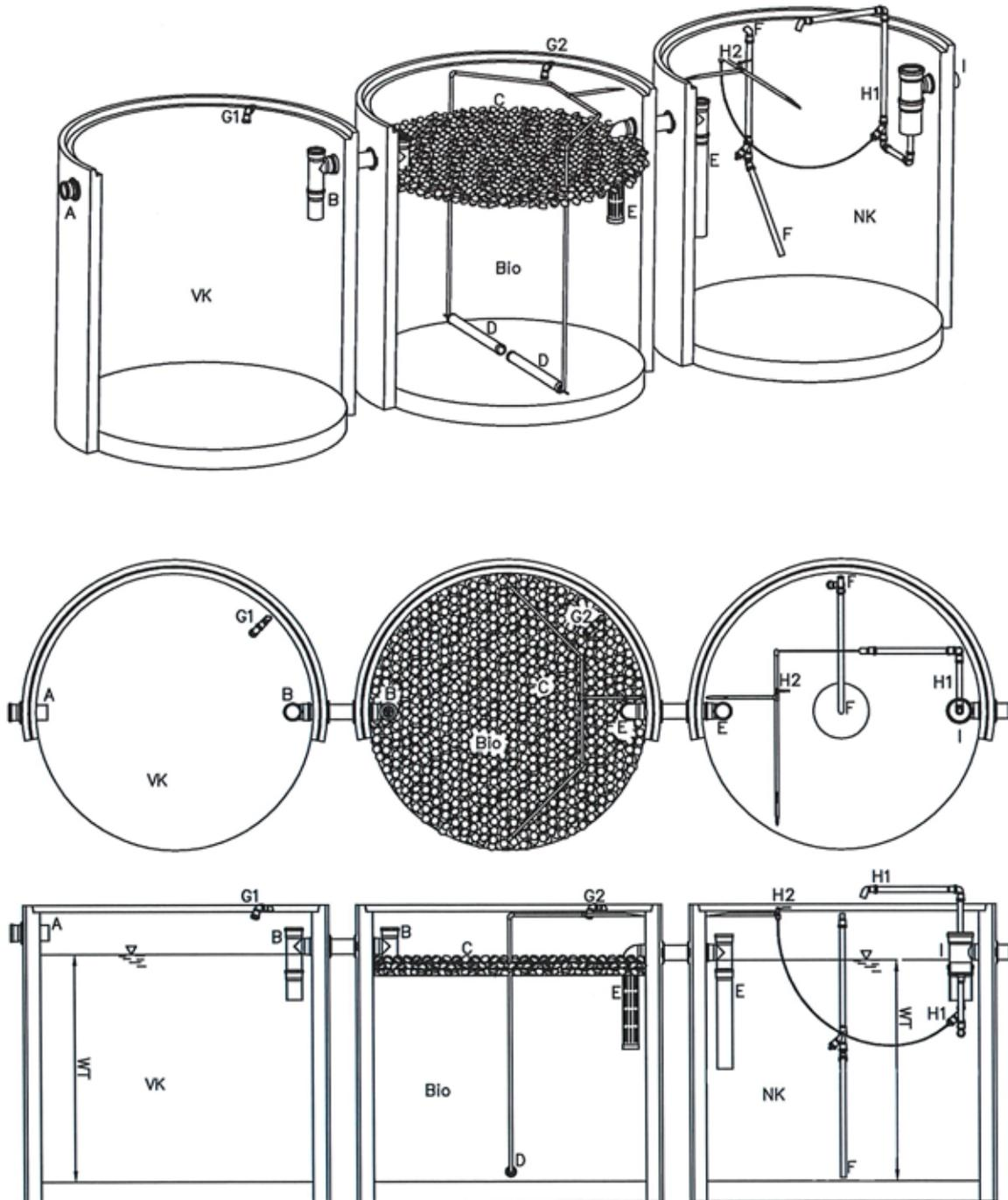
Nachrüstsetz Typ Picobells für den Einbau in bestehende Abwasserbehandlungsanlagen zur Herstellung von Kleinkläranlagen für 4 bis 50 EW; Ablaufklasse C
