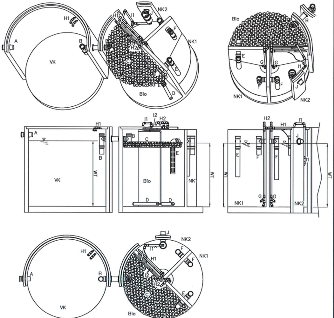
Nachrüstset Typ Picobells für den Einbau in bestehende Abwasserbehandlungsanlagen zur Herstellung von Kleinkläranlagen für 4 bis 50 EW; Ablaufklasse C
