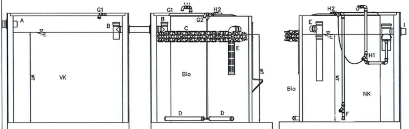
Nachrüstset Typ Picobells für den Einbau in bestehende Abwasserbehandlungsanlagen zur Herstellung von Kleinkläranlagen für 4 bis 50 EW; Ablaufklasse C
