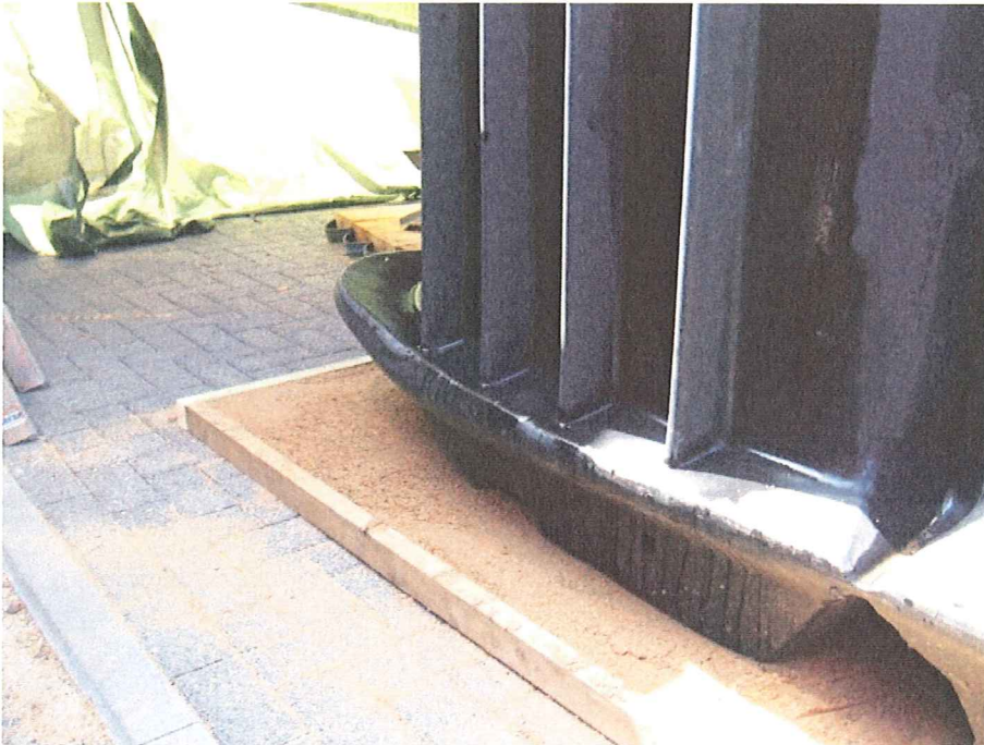
Bild 4: Verformung des PE-Behälters bei einer Belastung von über 149,7 kN
